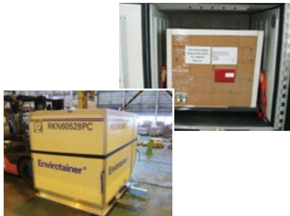
コンプレッサー式冷房機能が装備されたコンテナ
