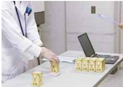
電子タグトレーサビリティシステムによる 薬剤情報の読み取り
